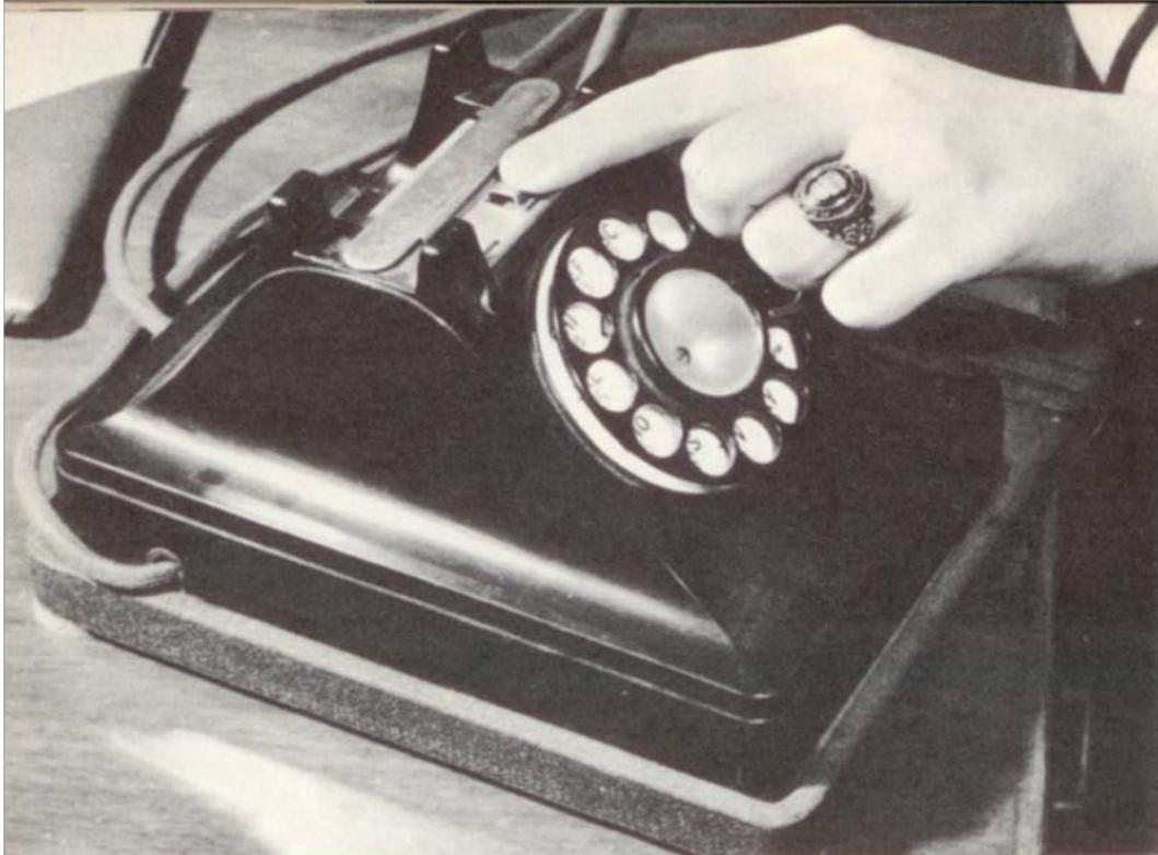
Mécanisme permettant de raccrocher lorsque le combiné doit être fixé sur un support.
